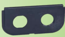
Un orificio de 21 x 19,6 mm para conector M21 x 1 y uno de M20 x 1,5 para glándula de cable.
